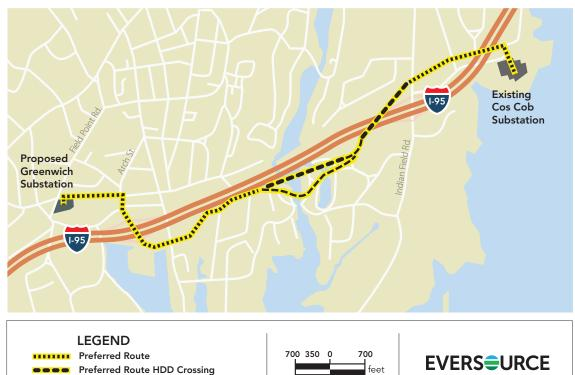
El mapa de arriba muestra el trayecto propuesto de la nueva subestación y las dos nuevas líneas de transmisión de 115 kV.
