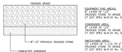
**PERVIOUS CRUSHED STONE SURFACE TREATMENT**
