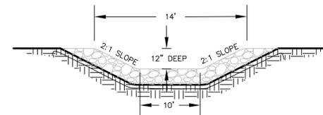
**EMERGENCY SPILLWAY SWALE FOR STORMWATER RENOVATION AREA A**
